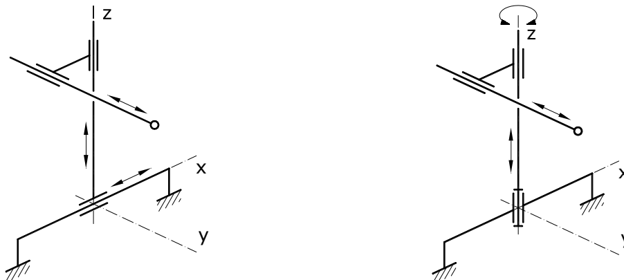
Obr. 1.2.1. – 2 Kinematická struktura T_x, T_z, T_y Obr. 1.2.1. – 3 Kinematická struktura R_z, T_z, T_y
